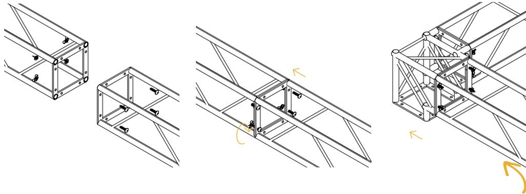
Les différentes sections s'assemblent facilement
