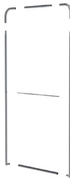
Ajoutez le renfort central et connectez l'ensemble des tubes à l'aide du système de repérage
