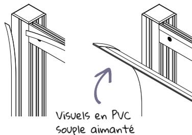
L'habillage par panneaux rigides (5mm) vous permet d'encaster directement le panneau dans la rainure du mât. Dans le cas où vous souhaitez habiller entièrement la structure, des velcro mâle et femelle seront utilisés au dos et sur la structure.
