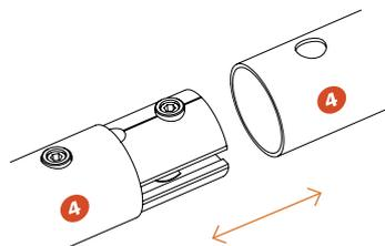
Verrouillage des sections par clé Allen
